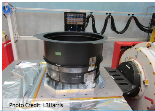
SM baffle & shade sine vibe burst test
